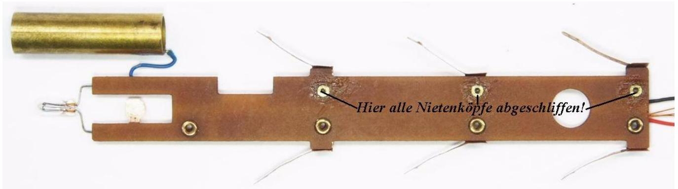
Nun wurden die Leiterbahnen zu dem Stirnlampen wie auch zum Rauchgenerator entsprechend geändert. Der Rauchrohrträger und die Stirnlampe erhält nun einen neuen gemeinsamen + als Rückleiter (Decoderfarbe blau). Der Rauchgenerator Mittelkontakt (Decoderfarbe grün) und die Stirnlampe (Decoderfarbe weiß). Diese 3 zusätzlichen Leitungen wurden mittels 0,25 mm Kupferlackdraht erstellt und später am Schneckendeckel mittels Hilfsplatinen mit den entsprechenden Decoderlitzen Richtung Tender verbunden.
