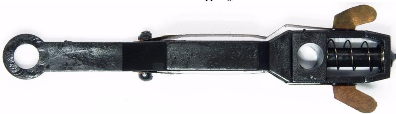
**An der umgebauten Kupplung wurden Schrumpfschlauch Stücke als Verrohrungshilfe angebracht!**
