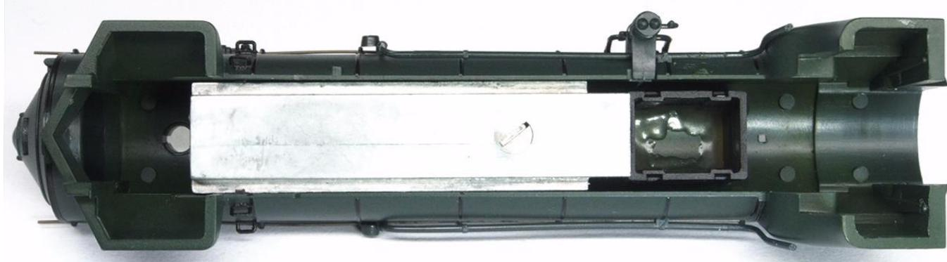
Die Klebestelle des Lautsprechers ist einfach zu lösen. Nachdem das Kesselunterteil, inklusive dem neuen Lautsprecher montiert ist, sollte eine Funktionsprüfung gemacht werden.
